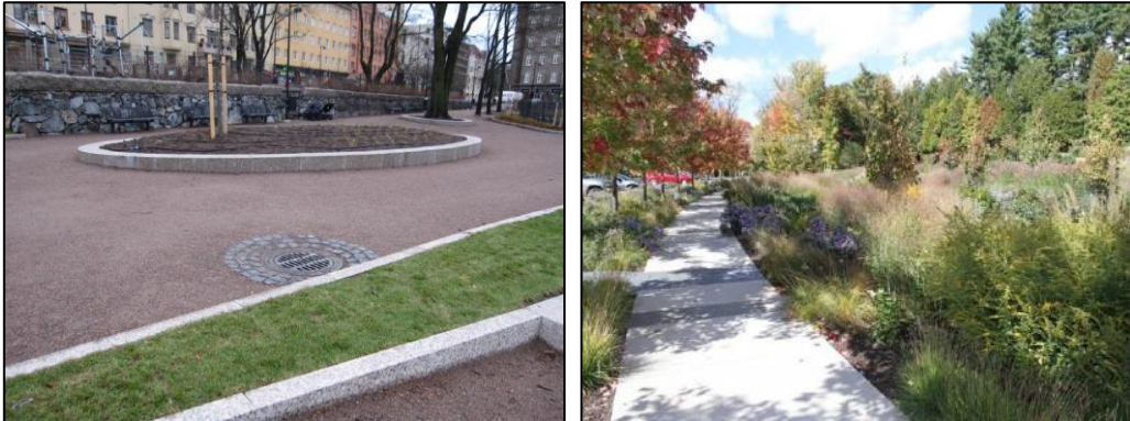
Kuva 16 Vasemmanpuoleisessa kuvassa kaupunkisuunnittelussa ei ole huomioitu hulevesien pääsyä läpäiseville pinnoille, kun taas oikeanpuoleisessa asia on huomioitu. (Wahlroos 2018)
